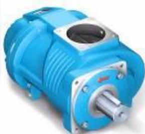
**Винтовой блок EVO15** производится компанией Rotorcomp (Германия) и является основой винтового компрессора. Визуально он представляет собой чугунный корпус, внутри которого, на подшипниках размещены два ротора, сжимающие воздух.
